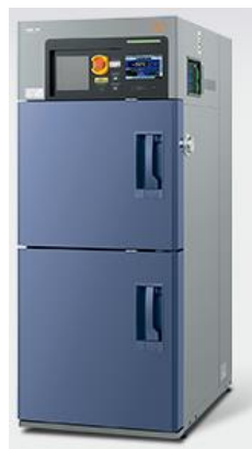
小型冷熱衝撃装置 TSE-12-A 2ゾーン方式
